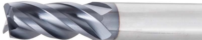
ISCAR ha lanzado recientemente la familia de fresas integrales **TI-TURBO** en una gama de diámetros de 6 a 20 mm. La nueva familia ha sido diseñada para operaciones de acabado y para el mecanizado a alta velocidad de ranuras principalmente, aplicando la técnica de fresado trocoidal. En esta técnica la fresa trabaja con pequeños anchos y grandes profundidades de corte siguiendo una trayectoria marcada por una curva trocoide. En estas condiciones la herramienta
